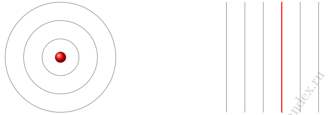
Рис. 1. Эквипотенциальные поверхности поля заряженного тела
